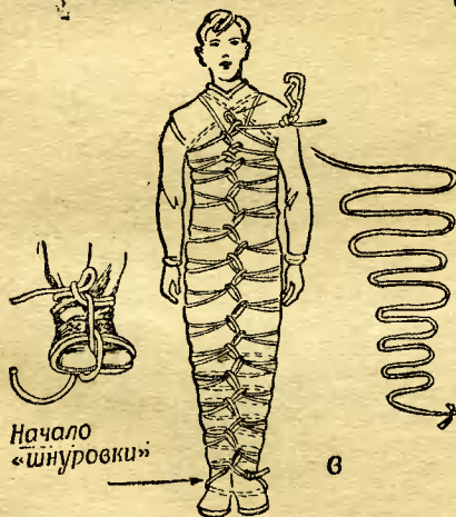
Р и с. 196. Носилки из веревок: а, б — плетенка; в — корзина; г — с использованием шеста
