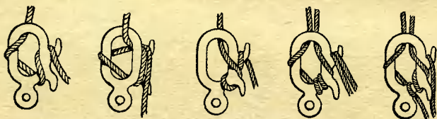
Рис. 153. Различные способы продергивания веревки при спуске «на рогатке»
